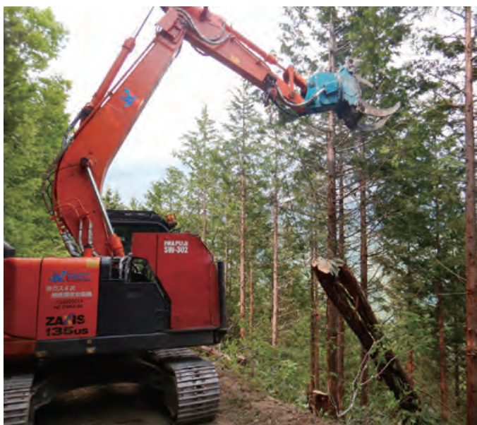
▲スイングヤードを使った集材作業（高山市）
