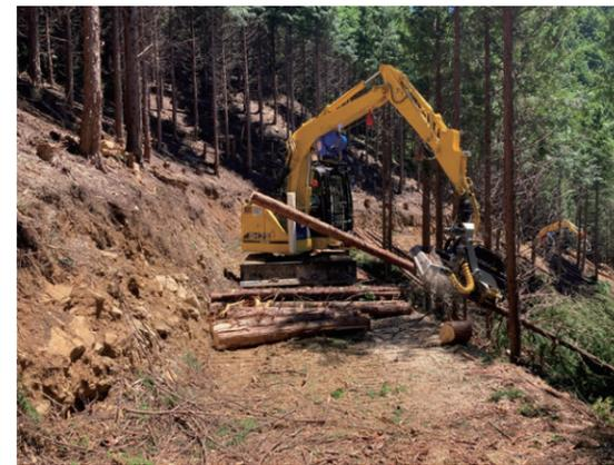
▲林業機械による造材作業（下呂市）
