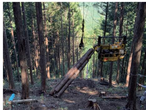
▲簡易架線と集材架線が交差する地点の様子(自走式搬器で集めた丸太を集材架線に移し替え、土場へ降ろす)
